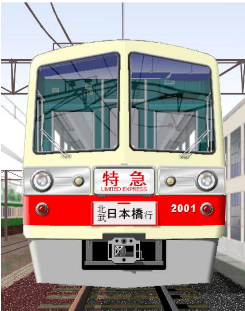
湘南型を近代化した一つの解答と言える前面。試験的にスカートが取り付けられている
